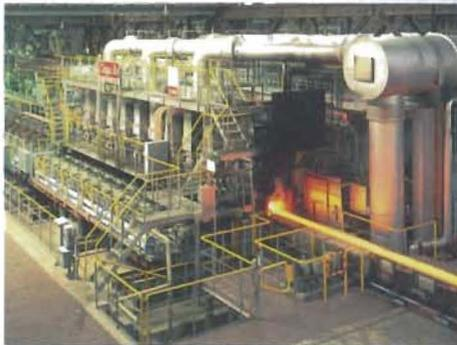
▲加熱炉 ビレットを約1,000℃に加熱します。
