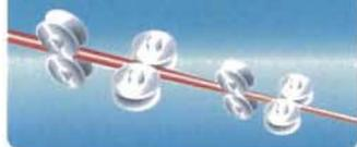
溝(カリバー)を加工した複数のロールの中に熱鋼(加熱したビレット)を順番に通します。熱鋼はカリバーの形状に変形し、断面積が小さくなり線材として製造されます。
