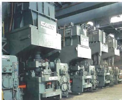
▲粗列圧延機 溝を付けたロールの中に熱鋼を通し、断面積を小さくします。
