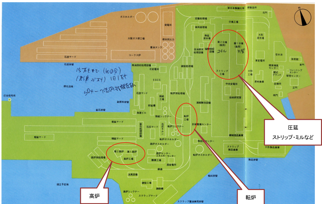
新日本製鐵 堺製鉄所 工場配置図 1981 年
