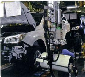
この工程では、塗装の完了したボディに各種の内装部品を取り付けます。作業をしやすくするため、ドアを取り外した状態で作業を行います。取り付けられる部品の種類は約6千種類(約3万点)で、まずクルマの内側に隠れてしまう各種ハーネスなどを取り付ける工程から始まります。次に、ヘッドライト等の電装品・インストルメントパネル・ガラス類・内張りなどが取り付けられ、続いて床下回りの部品・エンジン・サスペンション・プロペラシャフトなどを取り付けます。さらに、タイヤ・バッテリー・シート・ハンドルなどが取り付けられ、最後にガソリン・オイルなどを自動注入して車両が完成します。
